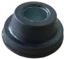
Descrição: Bucha da suspensão da barra estabilizadora
