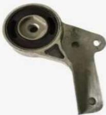
**Descrição:** Suporte lado esquerdo da suspensão do radiador**Aplicação:** Série 5 Highline**ADELMAR 1017**
