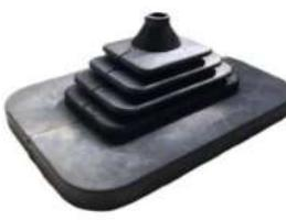
Descrição: Guarda pó do câmbio micro ônibus carroceria
