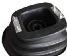
Descrição: Guarda pó inferior da alavanca do câmbio completo (com suporte plástico e parafusos de Fixação)
